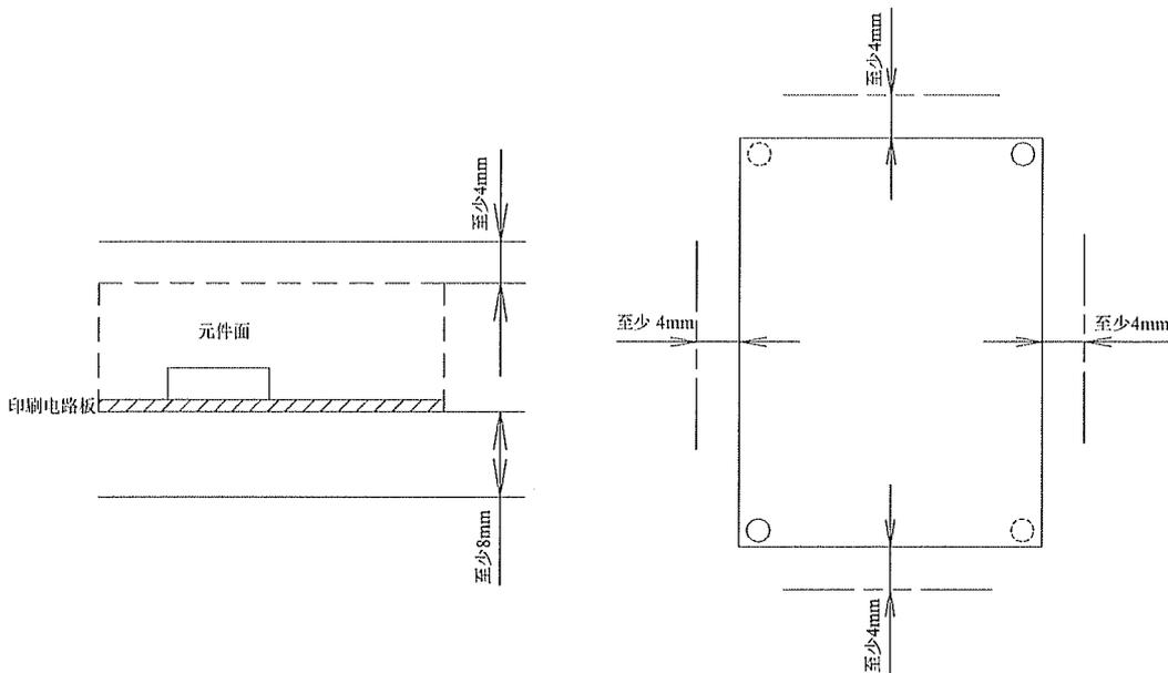
元器件侧上方和印刷电路板四周至少保持 4 毫米间隙，尤其是印刷电路板底面要至少保持 8 毫米的间隙。以确保满足绝缘和耐压规格，及保持空气对流，确保自然风冷的效果。
